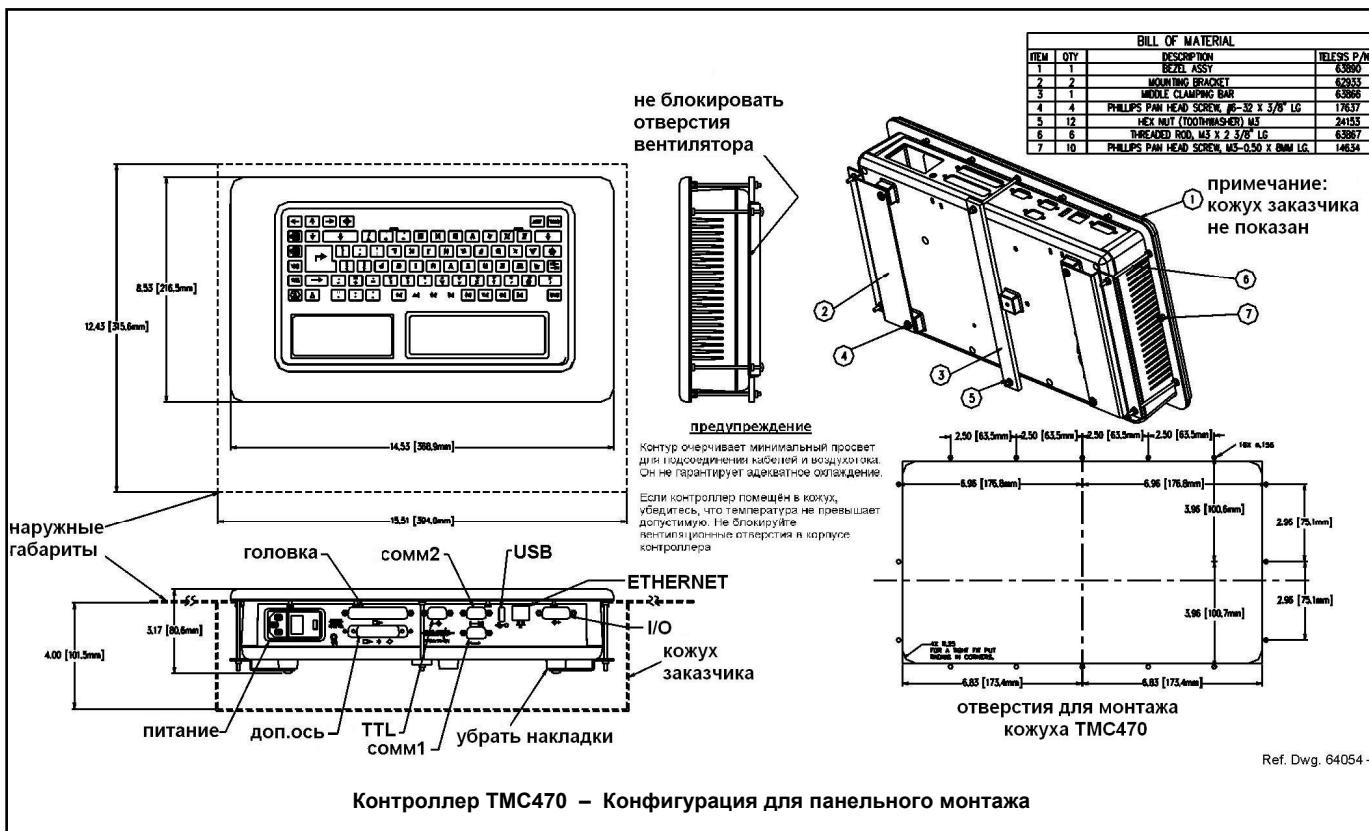
Контроллер TMC470 – Конфигурация для панельного монтажа
