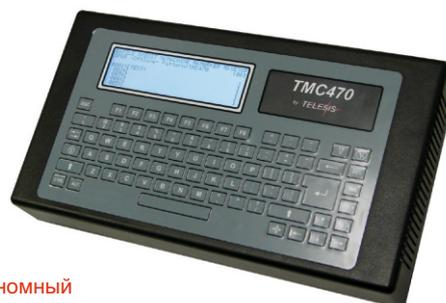
Компактный автономный контроллер TMC470
