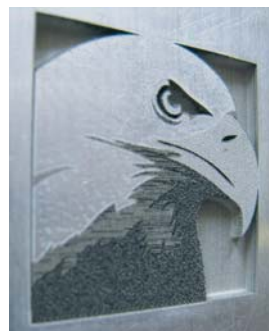
Гравировка на алюминии глубиной около 4мм
